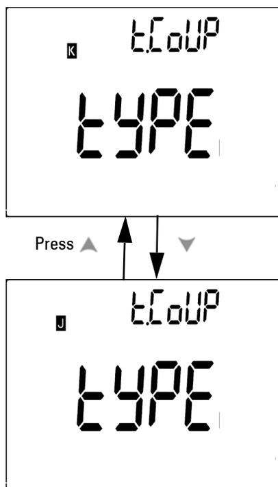
**Figura 4-3** Configuración del tipo de termopar
